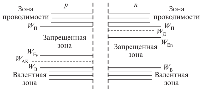
Рис. 1.26. Энергетическая диаграмма полупроводников до контактного соединения
