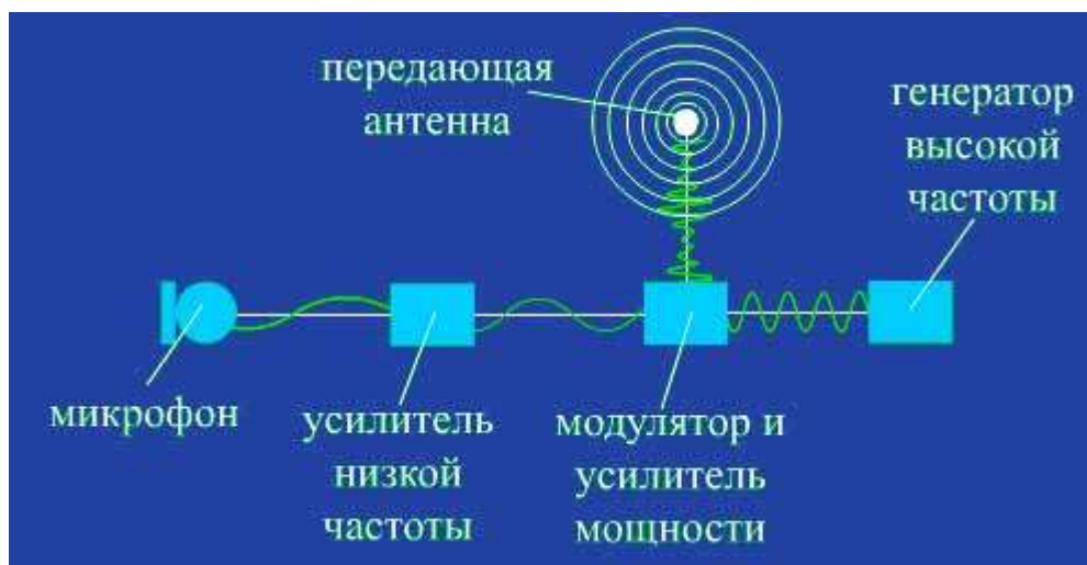
Рис. 1 Схема радиопередатчика
