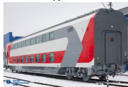
Рисунок 1 Двухэтажный пассажирский вагон
