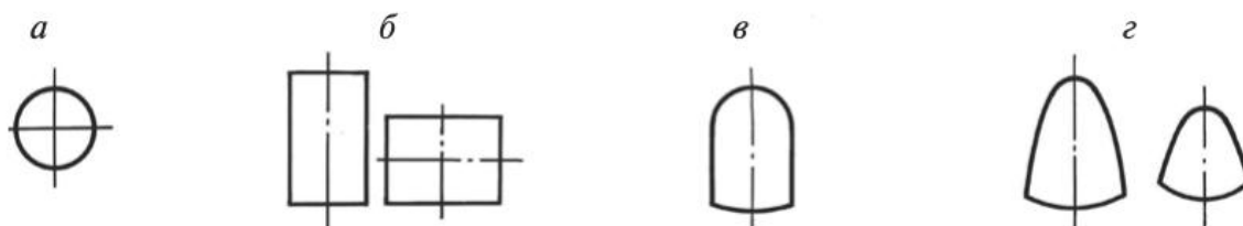
Рис. 11.1. Основные формы поперечного сечения труб: a — круглое; б — прямоугольное; в — с вертикальными стенками и полукруглым сводом; г — овоидальное
