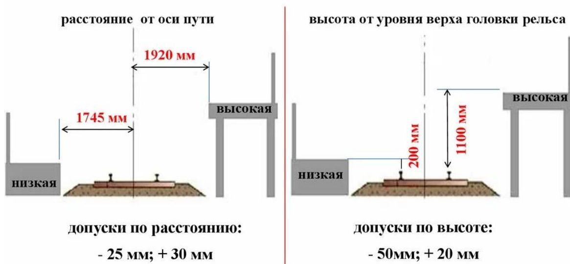
Рис. 3. Требования к пассажирским и грузовым платформам
