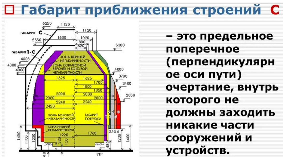
Рис. 1. Габарит приближения строений
