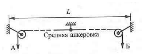
Рисунок 5. Схема двусторонней компенсации провода со средней анкеровкой
