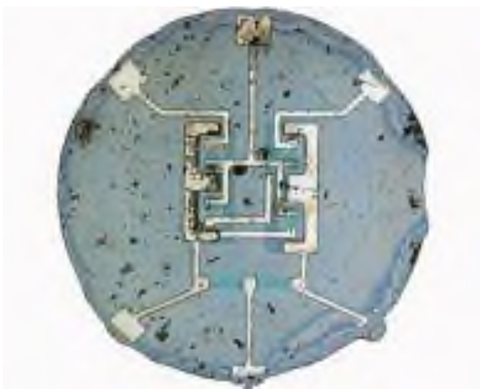
Роберт Нойс (сооснователь Intel) и его первая микросхема (содержит четыре транзистора и другие компоненты, уместающиеся на кристалле площадью 5...10 мм 2 ).
