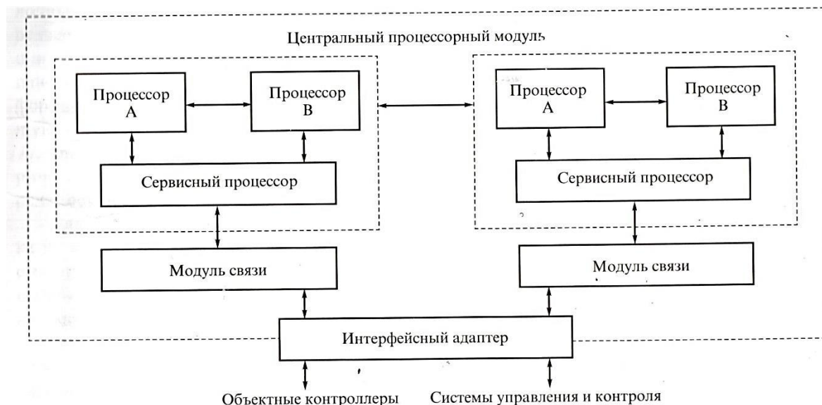
Рис. 11.6. Центральный процессорный модуль системы «Ebilock-950»
