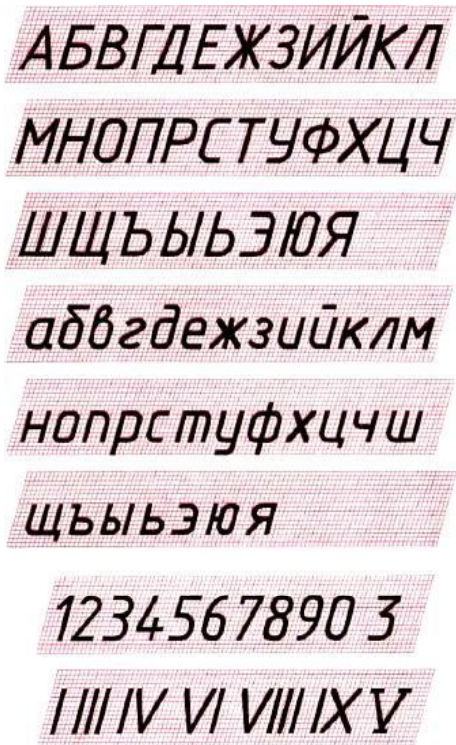
Рисунок 2 – Шрифт чертежный типа Б с наклоном около 75°
