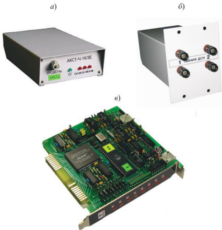
Рис. 22 Оборудование функционального контроля сигнальных точек автоблокировки: а – АКСТ; б – УСЛ; в – СЧД
