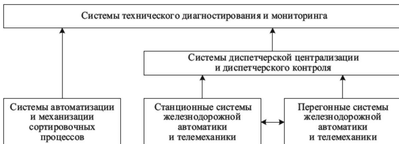
Рис. 17 Системы железнодорожной автоматики и телемеханики
