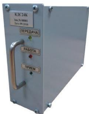
Рис. 17 Внешний вид контроллеров дискретной диагностической информации: а – ПИК-120 и КДС-120; б – КДС-24 К; в – ПИК 120.32
