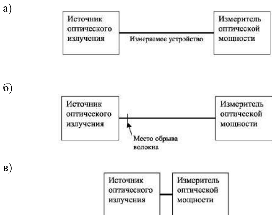
Рисунок 2.3 - Измерение потерь методом обрыва: а) измерение полных потерь в измеряемом устройстве; б) обрыв волокна вблизи источника; в) измерение введенной в тестируемое волокно мощности
