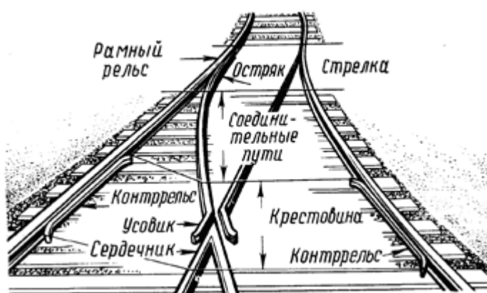
Рисунок 12 – Общий вид стрелочного перевода
