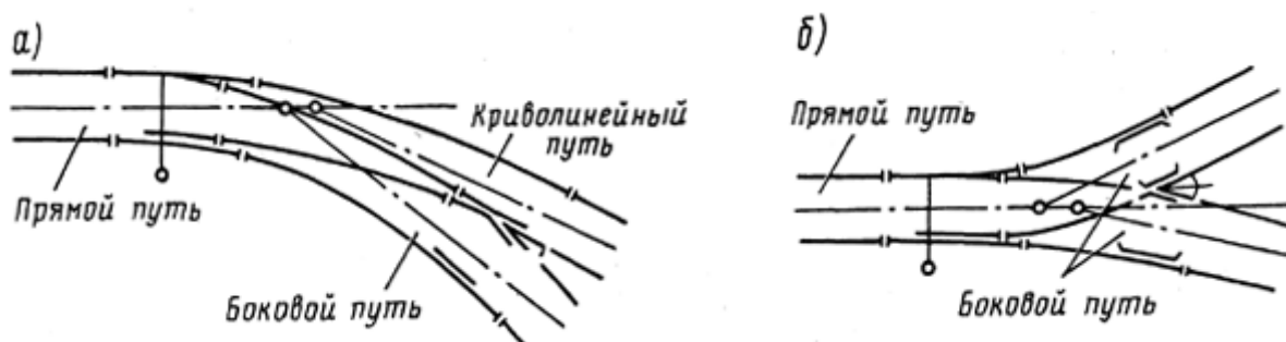
Рисунок 16 – Одиночные не симметричные стрелочные переводы: а – односторонний; б – разносторонний
