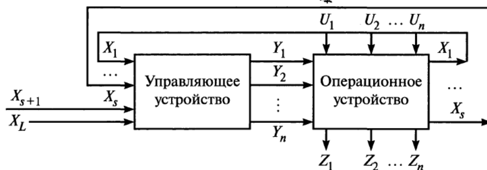
Рис. 8.1. Структурная схема процессора: X_1, \dots, X_s — определяют состояние (ОУ), X_{s+1}, \dots, X_L — внешние сигналы; U_1, U_2, \dots, U_n — входные данные; Y_1, Y_2, \dots, Y_n — сигналы управления; Z_1, Z_2, \dots, Z_n — выходные данные
