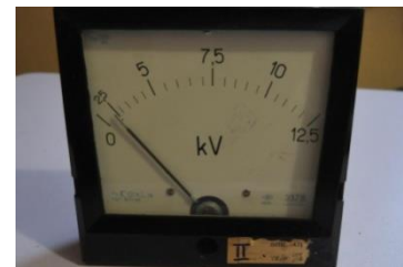
Рис.2 а - милливольтметр; б – вольтметр; в – киловольтметр.
