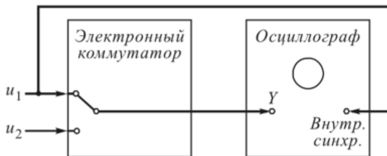
Рис. 7.2. Метод линейной развертки
