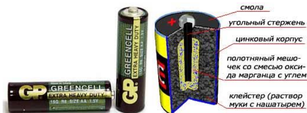
Рисунок 84- Внешний вид и устройство "сухого" гальванического элемента
