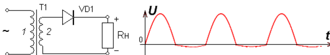
Рисунок 33- Однополупериодный выпрямитель при прямом включении
