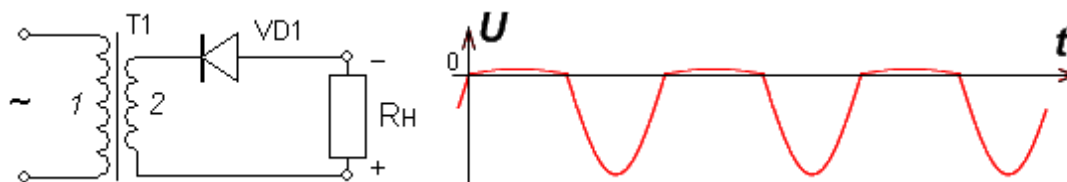
Рисунок 34- Однополупериодный выпрямитель при обратном включении
