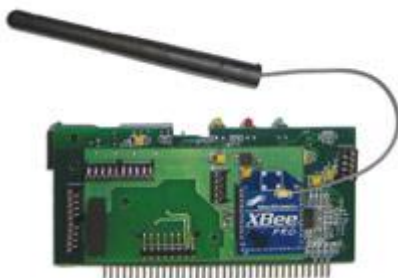
Рис. 9. Управляющий контроллер с интегрированным ZigBee-модулем
