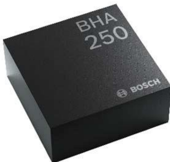
Рис. 4. BNA250 от Bosch Sensortec, объединяющий 32-разрядный микроконтроллер с 14-разрядным датчиком ускорения в компактном корпусе 2,2 x 2,2 x 0,95 мм
