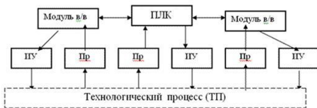
Рисунок 14.2 - Типовая функциональная схема одноуровневой системы автоматического управления САУ.
