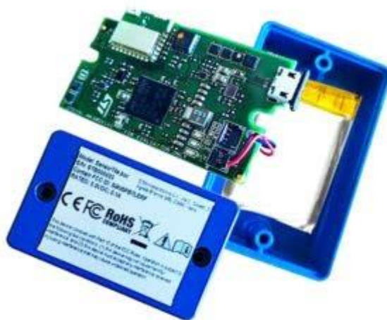
Рис. 6. Внешний вид модуля SensorTile.box с интегрированным Arm Cortex-M4 и датчиками
