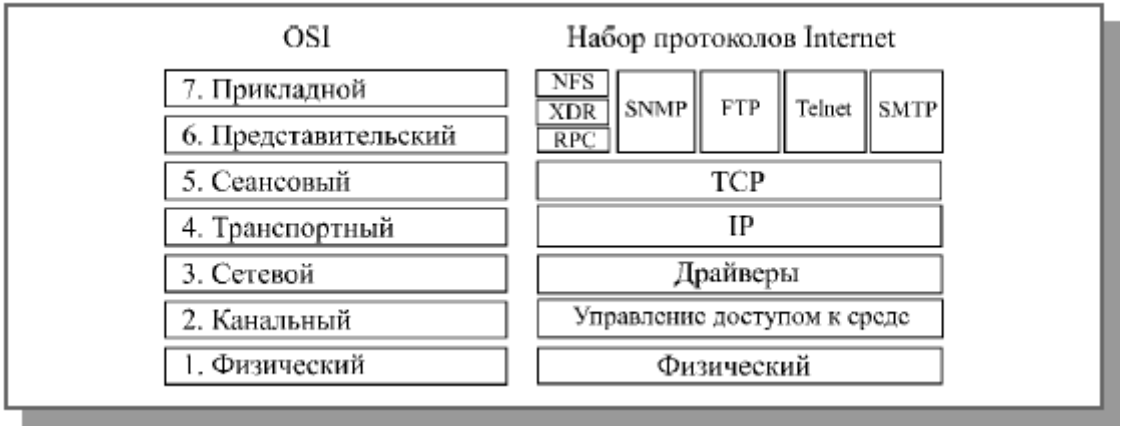
Рис. 6.2. Соотношение уровней модели OSI и протоколов сети Интернет
