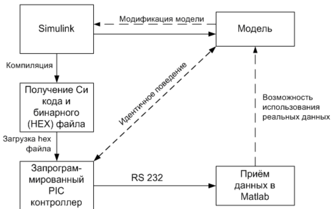
Рис. 11. Структура средств построения адекватной модели PIC контроллера на языке графического программирования.
