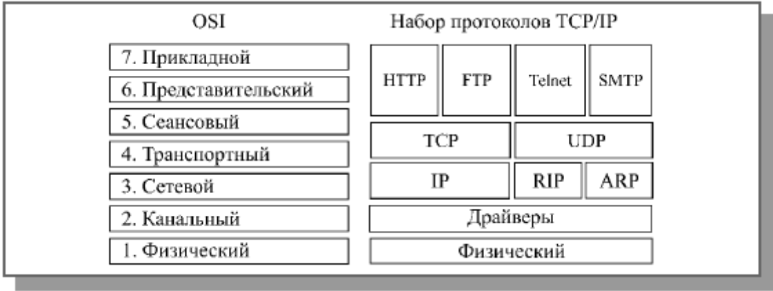
Рис. 6.7. Соотношение уровней модели OSI и стека протоколов TCP/IP
