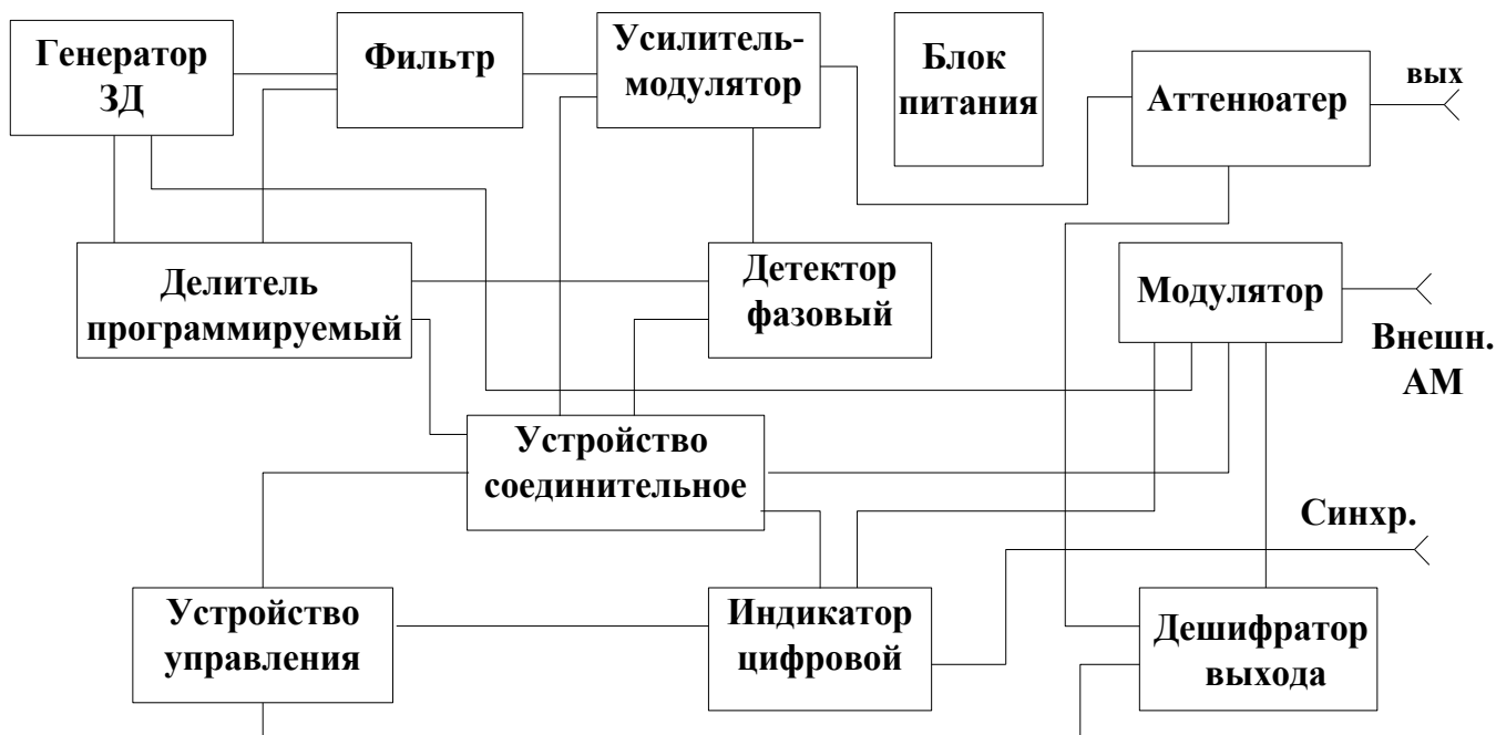
Рис. 2 Структурная схема генератора Г4-158
