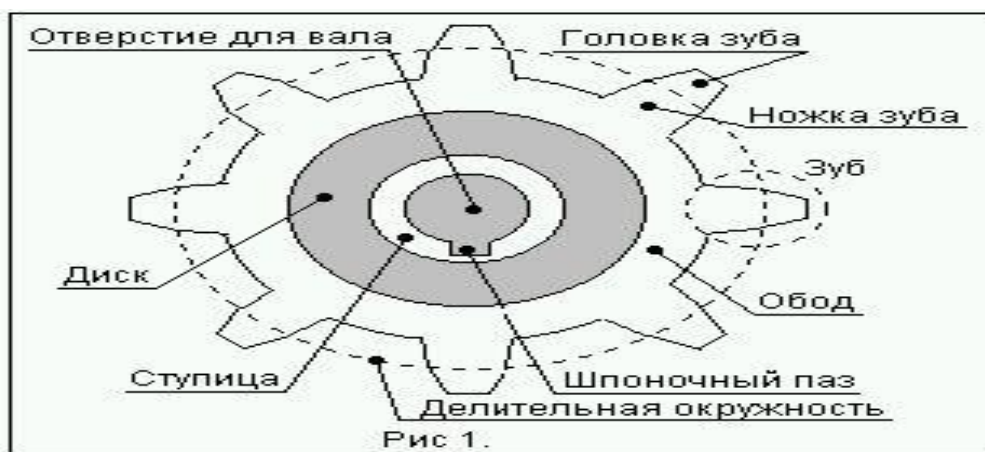
На Рис. 1 показано устройство зубчатого колеса.
