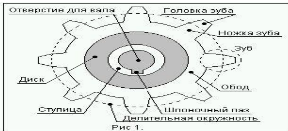
На Рис. 1 показано устройство зубчатого колеса.
