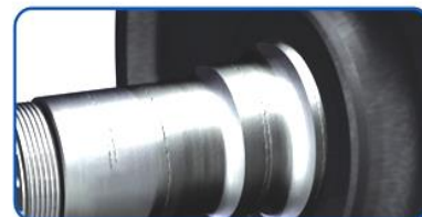
Трещины в шейке, предступичной и подступичной частях оси.
