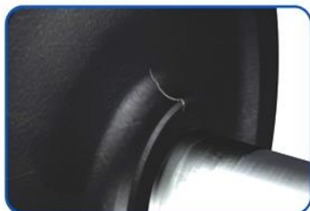
Трещина в ступице колеса.
