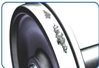
Выщербины, вмятины на поверхности катания бандажа глубиной более 3 мм, длиной более 10 мм; на вершине гребня – длиной более 4 мм.
