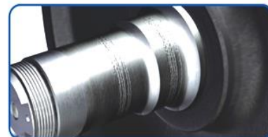
Поперечные задиры шеек или предступичных частей оси.
