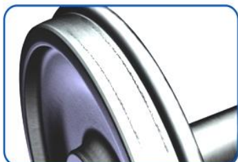
Кольцевая выработка на расстоянии до 40 мм от наружного торца бандажа глубиной более 2 мм и шириной более 15 мм, на других участках поверхности катания бандажа глубиной более 1 мм и шириной более 2 мм.
