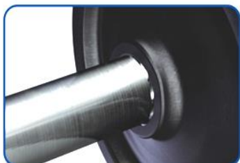
Сдвиг ступицы колеса на подступичной части оси, ослабление ступицы колеса на оси. Признаком ослабления ступицы является разрыв краски по всему периметру с выделением из-под ступицы с внутренней стороны колеса жидкости или масла.
