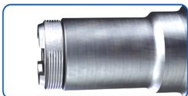
Повреждения резьбы под гайку торцевого крепления.
