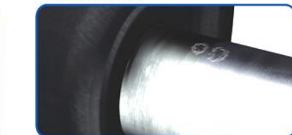
След контакта с электродом или электросварочным проводом в любой части оси (электрожоги и плены).
