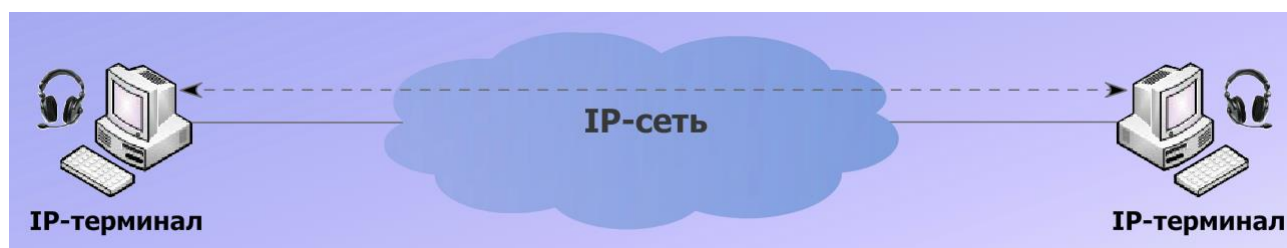
Рисунок 6.16 – Сценарий IP–телефонии «компьютер–компьютер»
