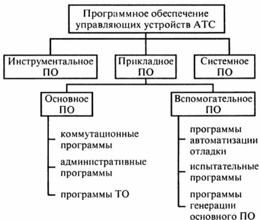
Рисунок 3.12 - Структура программного обеспечения
