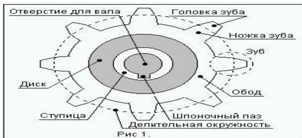
На Рис. 1 показано устройство зубчатого колеса.
