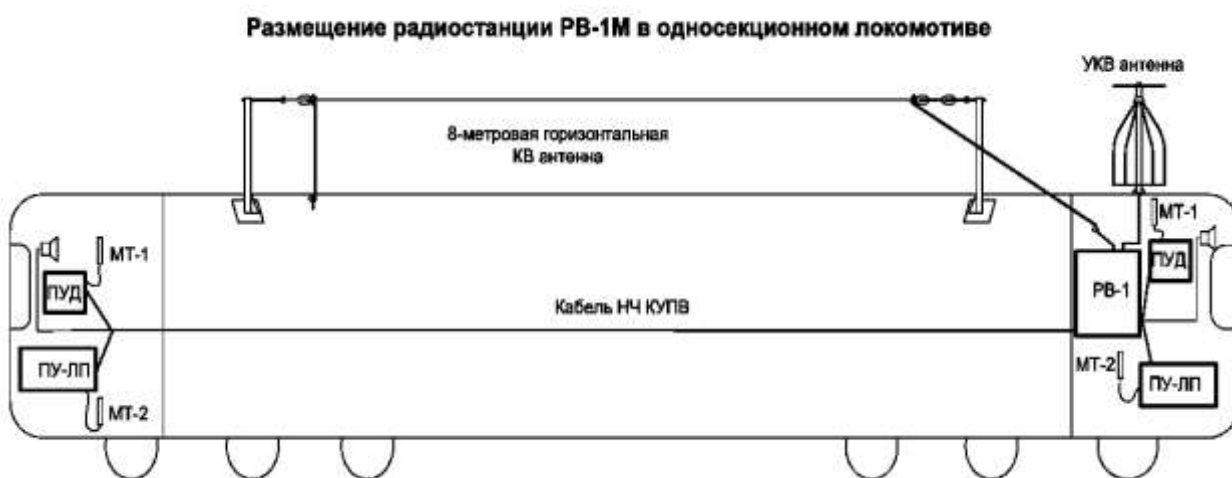
Рис. 20 Размещение радиостанции в односекционном локомотиве
