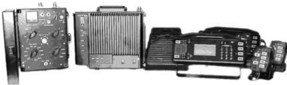
Рис. 24 Общий вид радиостанции РВС-1 (слева направо): блок согласования антенны, блок БАРС, громкоговоритель, пульт управления ПУ, дополнительный пульт управления ПУ-Д
