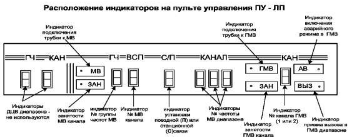
Рис. 23 Расположение индикаторов на ПУ-ЛП
