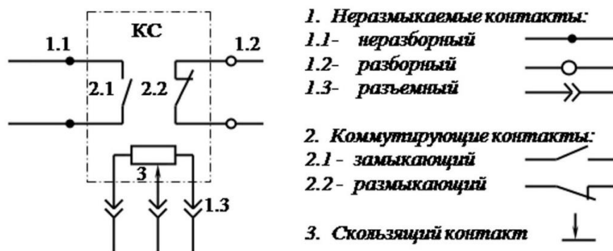
Рис. 1.1 Классификация контактов по характеру соприкосновения элементов контактного соединения.
