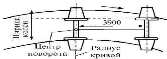
Рис. 1.33 Схема свободного вписывания вагона
