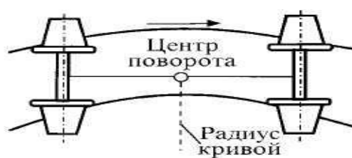
Рис. 1.34 Заклиненное вписывание вагона
