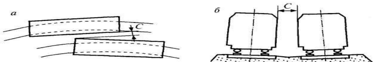
Рис. 1.87. Сближение экипажей при скрещении в кривых: а — в плане; б — в вертикальной плоскости
