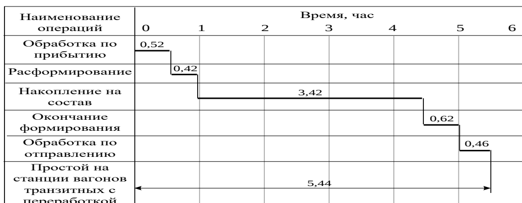
Рис. 10.1. График простоя на станции вагонов транзитных с переработкой
