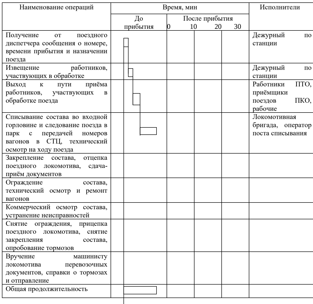
Рис. 4.1. График обработки транзитного поезда со сменой локомотива
